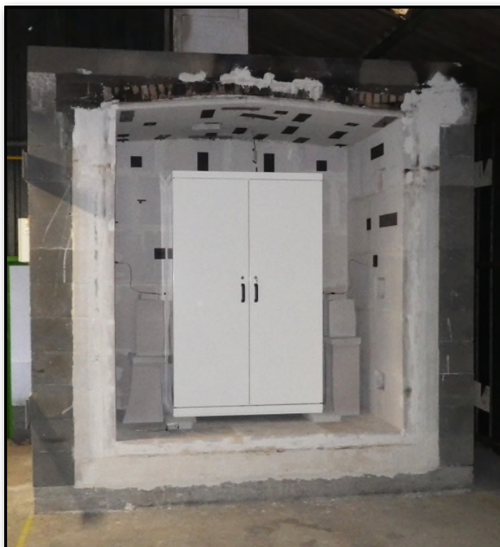
▲ Armoire 795BG mise en place dans le four pour test au feu selon la norme EN 14470-2 (photographie avant essai)
