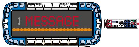
2 x 10 modules à 3 LED Solaris - bleu - Signalmaster à 6 modules Solaris - 2 x 2 take down - 2 x 2 alley lights - double panneaux à message variable rabattable (message vers l'avant - texte rouge - message vers l'arrière - texte rouge - défilement orange) - Connecteur de toit CT19 - Kit de fixation - Boîtier de commande BCT3000 inclus
