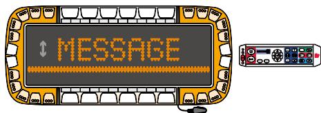
2 x 10 modules à 3 LED Solaris - Orange - double panneaux à message variable rabattable (message vers l'avant - texte orange - message vers l'arrière - texte orange - défilement orange) - Connecteur de toit CT19 - Kit de fixation - boîtier de commande BCT3000 inclus
