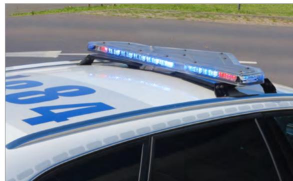
La forme si caractéristique de la Valor résout le problème des angles "hors-axes" situés entre 45° et 90°.
